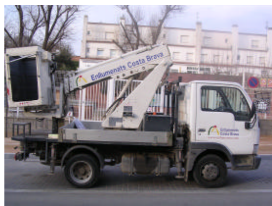
Camió amb cistella per alçades de fins a 10 mts Amb diàmetre curt de gir (carrers estrets).
